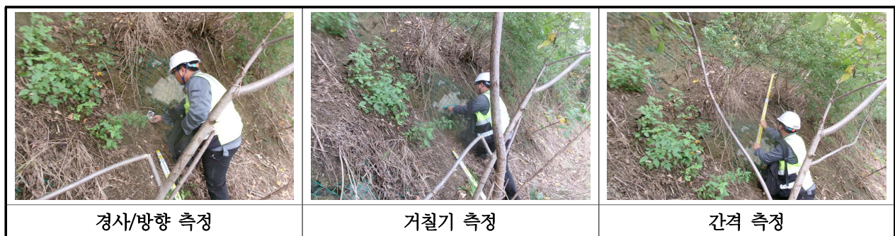
【사진 3.3.3】 불연속면 측정 현황
